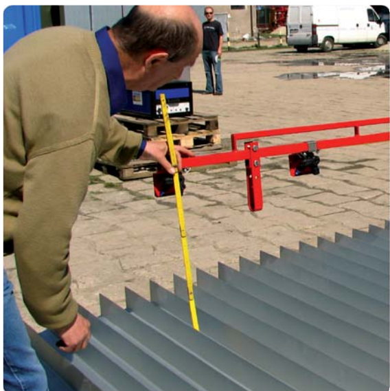
Odpowiednia wysokość belki nad powierzchnią opryskiwaną (ok. 50 cm).
