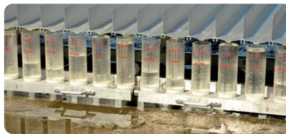
Poniżej 50 cm nad powierzchnią opryskiwaną - ciecz robocza rozkłada się nierównomiernie.
